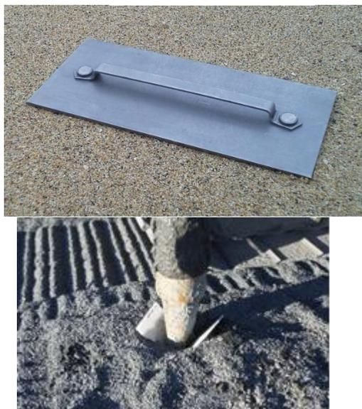
なお、ジオドレーン工法では鉄製のアンカープレートのほか、プラスチックの弾塑性的な性質を利用したアンカープレートも用意しています。
